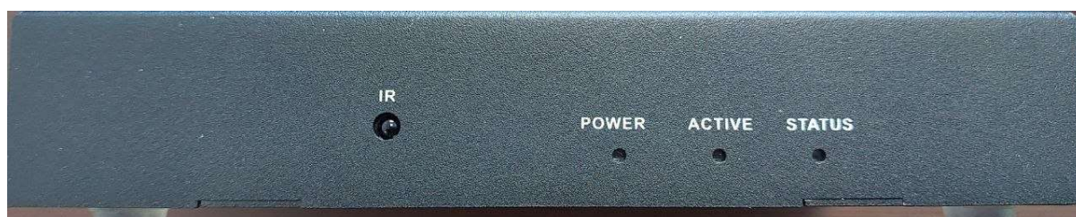
Рис. 1. Передняя панель: ИК-приёмник и светодиодные индикаторы.
