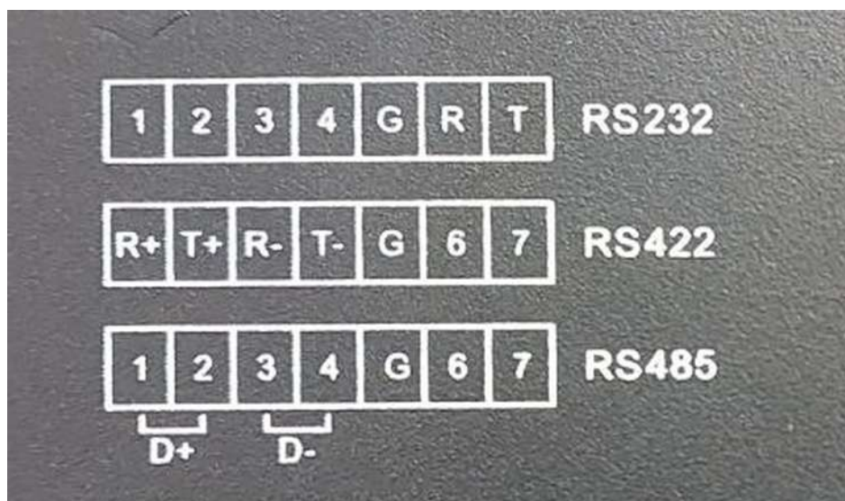
Рис. 3. Распиновка клемм COM-порта по протоколам (маркировка на корпусе).
